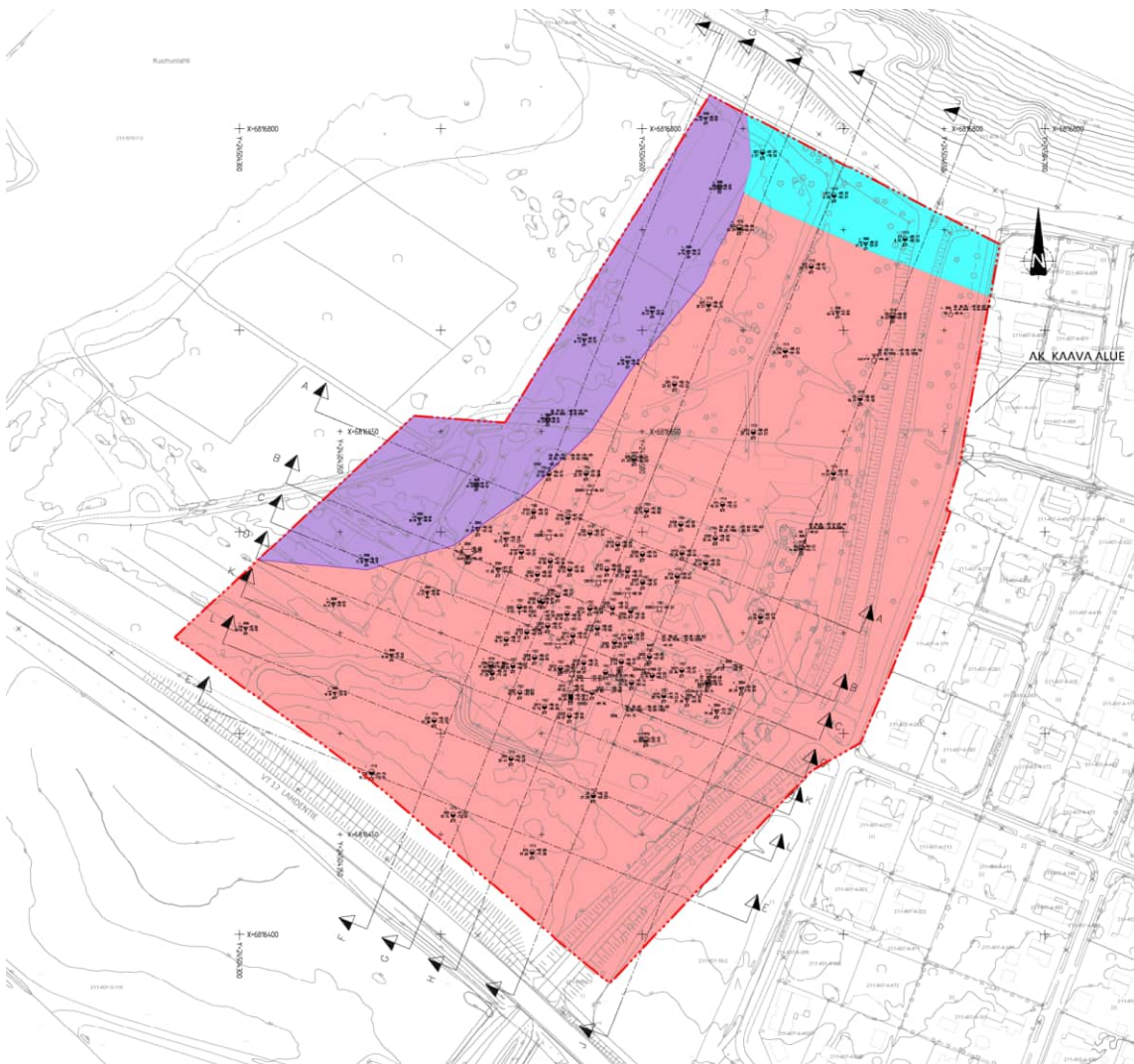
Kuva 45. Ote rakennettavuusselvityksen liitteenä olevasta tutkimus-rakennettavuuskartasta (Ramboll Finland Oy 2026). Kuvassa rakennettavuudeltaan melko huonoiksi luokitellut alueet on merkitty sinisellä, huonoiksi luokitellut alueet punaisella ja heikoiksi luokitellut alueet violetilla värillä.
