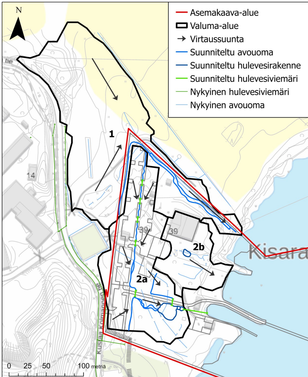
Kuva 13 Tulevan tilanteen mukaiset valuma-alueet, rummut, hulevesirakenteet ja ojat. (MML)
