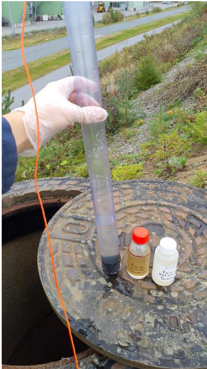
Kuva 5. Hulevesien kokoomakaivon näyte.
