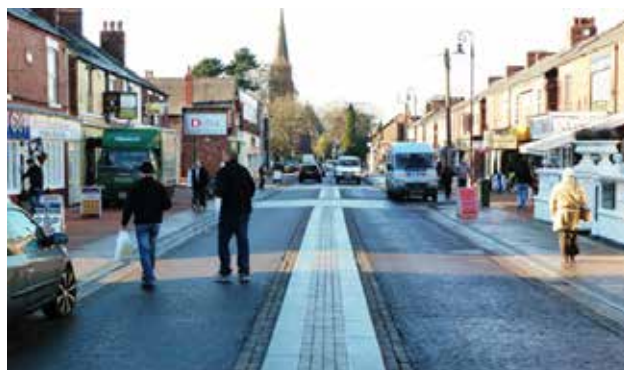
KUVA 17. Pikkukaupungin vilkas kauppakatu on toteutettu shared space- periaatteella. Poynton, Iso-Britannia. (Civic Engineers)
