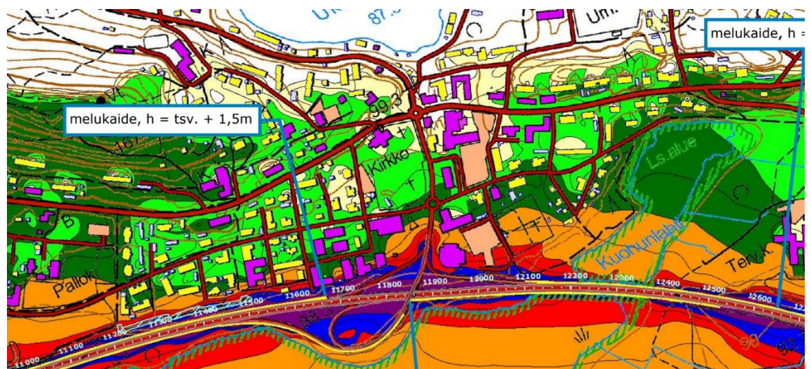
Kuva: Ote VT 12 parantamishankkeen meluselvityksestä, päivämelutasot vuonna 2040 huomioiden esitetyt meluntorjuntatoimenpiteet. Suunnittelualueen jaksolle ei ole osoitettu melukaidetta.
