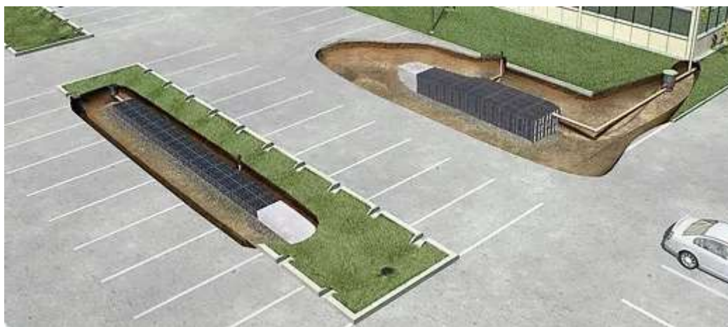
Kuva 8. Maanalainen hulevesien viivytys (Uponor).
